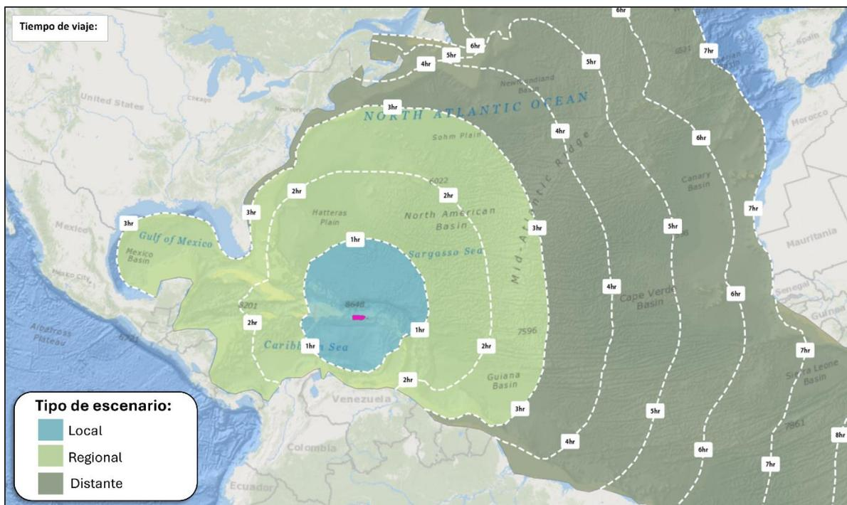
**Figura 12:** Mapa de tiempo estimado de arribo de un tsunami en la cuenca del Atlántico. Datos obtenidos de la herramienta Tide Tool (PTWC). Los diferentes colores muestran tres tipos de escenarios: tsunami local, regional o distante (tele-tsunami).
